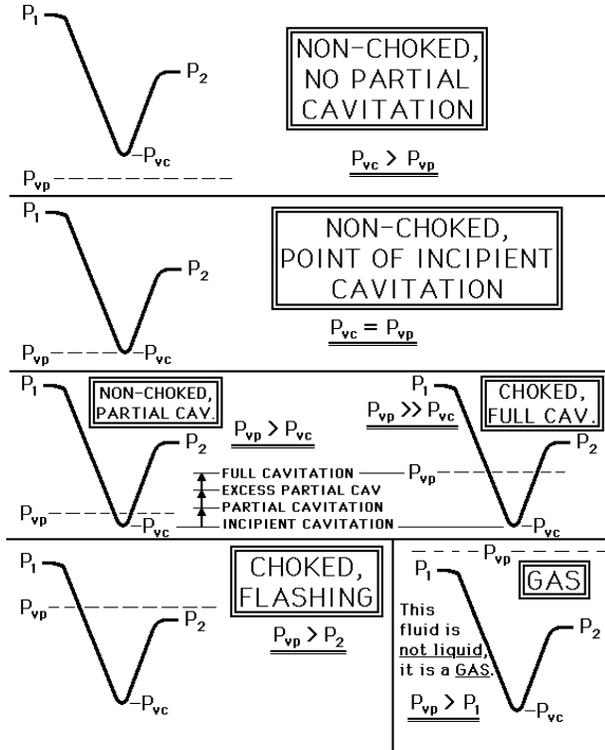
**LIQUID FLOW - VAPORIZING -**
